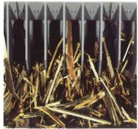
2 Abb. 3: Altholzaufbereitung für Grobzerkleinerung durch den langsamlaufenden Vorzerkleinerer „Dracula“, Abtransport des Materiales mit Bändern und Separierung der bereits losgelösten Eisenteile durch Überbandmagnet
